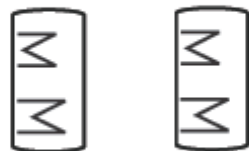
Zásobníky 1 a 2 s tepelným výměníkem
