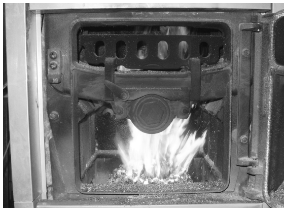
Obr. č. 29 Optimální tvar plamene
