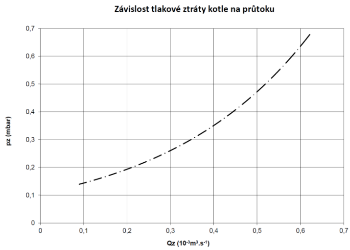
Obr. č. 2 Hydraulická ztráta kotlového tělesa
