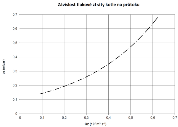
Obr. č. 2 Hydraulická ztráta kotlového tělesa
