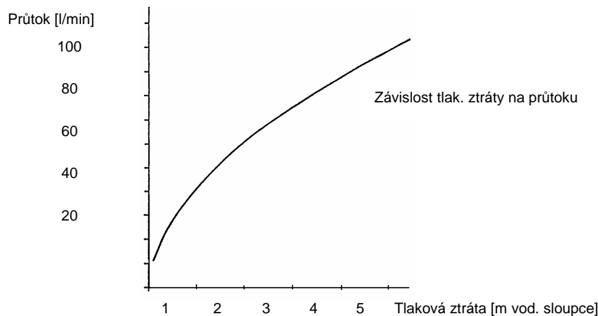
Obr. č. 11 Charakteristika trojcestného ventilu Honeywell V 4044F
